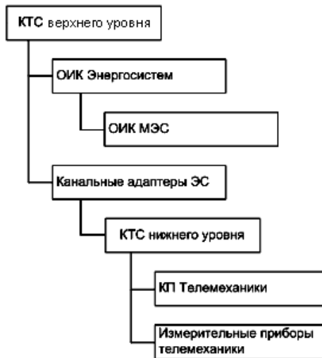
Рис. 1 – Структурная схема передачи данных телемеханики
